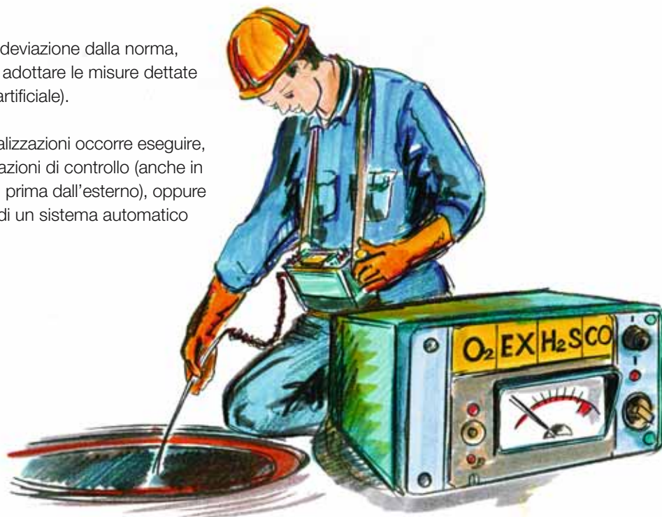
Figura 7: prima di entrare nella canalizzazione si eseguono misurazioni per accertare l'eventuale presenza di ossigeno, gas e vapori infiammabili, idrogeno solforato, monossido di carbonio.
