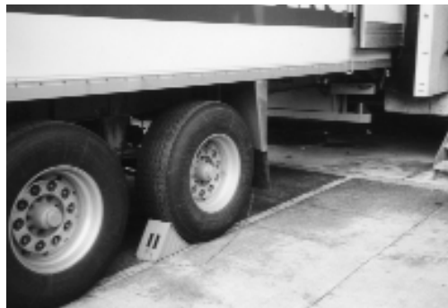
Il personale addetto alle operazioni di carico e scarico merci è sicuro che il veicolo le cui ruote sono state bloccate con l'apposito cuneo (calzatoio) non può mettersi in moto inavvertitamente.
