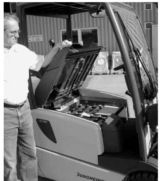
Fig. 5: sollevando il coperchio del cofano batteria durante la carica si permette la dissipazione della miscela esplosiva di gas.
