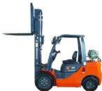
Per i muletti a gasolio o a benzina, oltre alla normale verifica della batteria, accertarsi del livello dell'olio motore e dell'acqua del circuito di raffreddamento.
