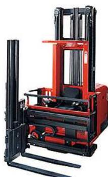
Per certi tipi di Carrelli Elevatori, come i cosiddetti retrattili per i magazzini, le protezioni di trattenuta non sono obbligatorie: in quanto lavorano, su una pavimentazione liscia senza pendenze, il che identifica un rischio di ribaltamento molto basso.
