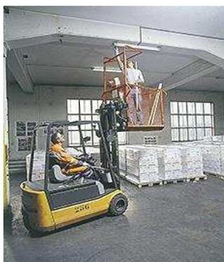
Prestiamo sempre attenzione alla velocità e per sicurezza tenete il piede sul pedale del freno. Ma ... in particolare ... muoviamoci sempre in rettilineo con le forche a monte, a velocità ridotta senza compiere ... mai proprio mai ... sterzate o inversioni di marcia.
