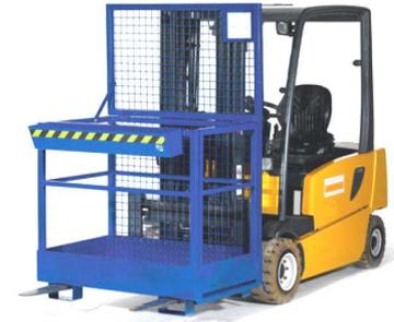
Ad ogni modo, e in momenti occasionali, è possibile alzare un'altra persona mediante l'uso di apposite ceste. La costruzione e la relativa commercializzazione delle ceste per carrelli elevatori, debbono avvenire, però, nel rispetto delle norme di sicurezza.
