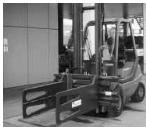
Figura 3: organo di presa per il trasporto di balle. Occorre usare sempre l'organo di presa appropriato.
