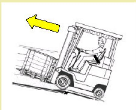
La stabilità del carrello elevatore è maggiore quando si percorrono tratti in pendenza con il carico a *monte*.
