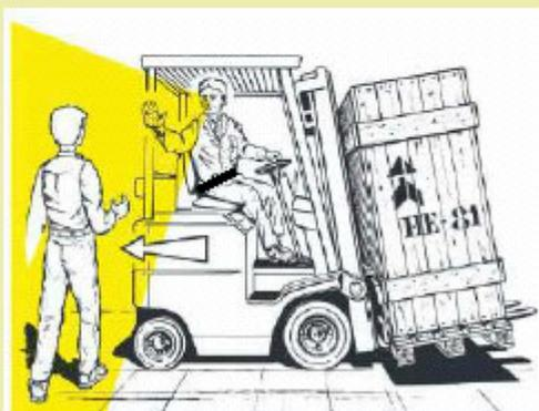
Per avere una sufficiente visibilità quando si trasportano carichi voluminosi è necessario procedere a marcia indietro, inoltre devono essere installati specchietti retrovisori per facilitare la rilevazione di ostacoli durante le manovre.
