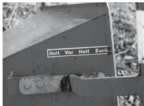
Fig. 2: le posizioni di comando devono essere segnalate in modo chiaro sulla staffa di comando dell'alimentatore.
