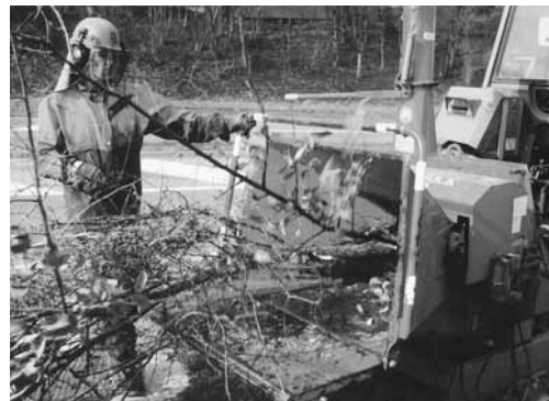
Fig. 1: la staffa di comando laterale e superiore può essere azionata in qualsiasi momento.
