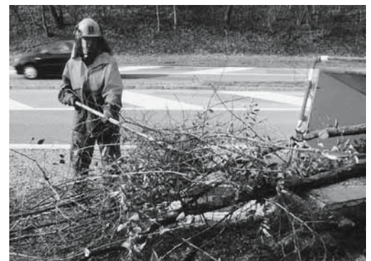
Fig. 5: gli scarti vegetali vengono introdotti nei rulli mediante un bastone lungo o appoggiati sui rami più grandi.
