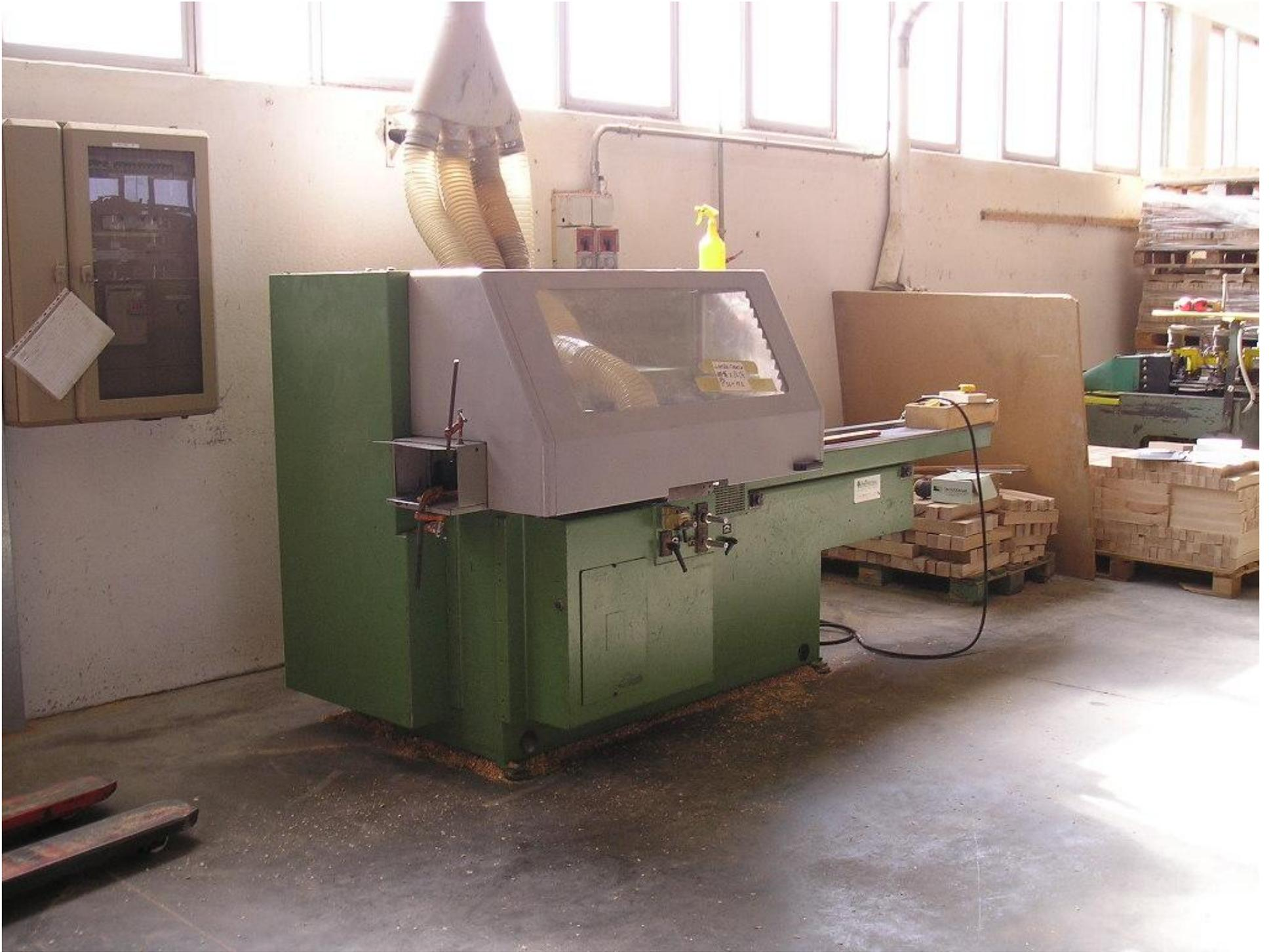
La carenatura di protezione (riparo mobile) deve essere provvista di un **dispositivo di interblocco con bloccaggio del riparo** tale da non permetterne l'apertura se non dopo l'arresto di tutti i movimenti di taglio e d'avanzamento della macchina direttamente accessibili.
