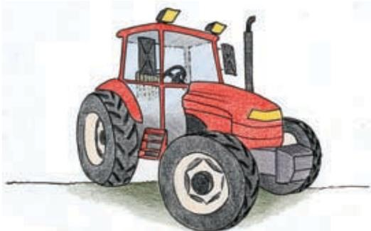
L'operatore si protegge allacciandosi sempre le **cinture**, riparato dalla **cabina, telaio o roll bar**. Tali dispositivi di sicurezza lo trattengono, in caso di ribaltamento, entro un volume non interessato dalle deformazioni del mezzo, limitando così il pericolo di schiacciamento.
