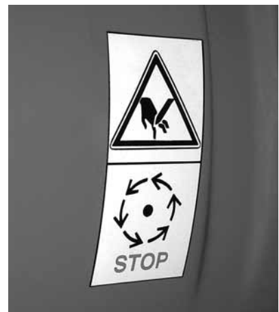
Foto 9: lavorare sulla fresa solo quando è spenta.
