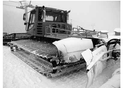
Foto 5: ad eccezione di situazioni di emergenza non è consentito trasportare persone sul ponte di carico.
