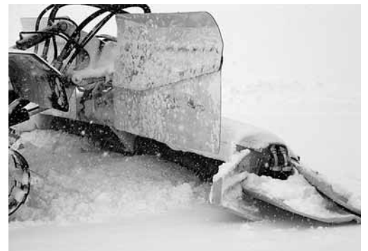
Foto 6: la fresa posteriore deve essere spenta quando qualcuno si avvicina al mezzo.
