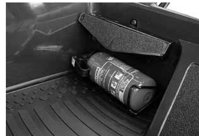
Foto 8: estintore in dotazione al veicolo battipista.
