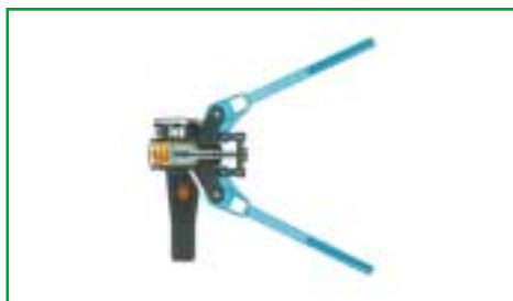
Fig. 10 - Organo bacchiatore di bacchiatrice pneumatica.
