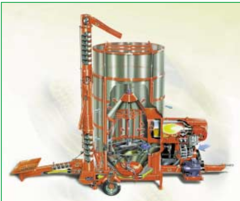
Fig. 2 - Sezione schematica di un essiccatoio mobile con coclea verticale esterna (Ditta Agrex).
