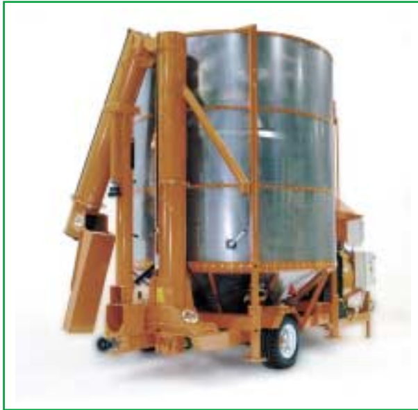
Fig. 6 - Essiccatoio mobile con coclee di carico verticale ripiegata per il trasporto (Ditta Agrex Spa).
