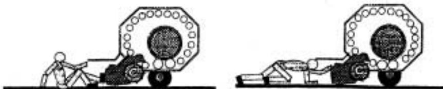
Fig. 12 - Con la spinta verso il pick-up la massa vegetale si sblocca e gli organi di lavoro riprendono il loro movimento con il rischio che l'operatore sia trascinato nella camera di compressione.
