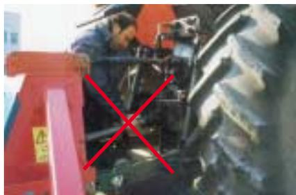
*L'albero cardanico deve essere dotato di protezioni idonee per tutta la lunghezza dell'albero e dei giunti cardanici sia sull'operatrice che sul trattore.*
