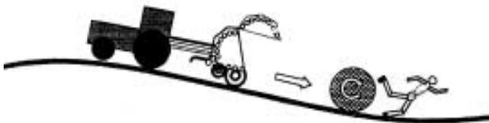
Fig. 14 - Quando si scarica la palla occorre fare attenzione ai pendii.
