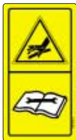
Fig. 12 - Pericolo di eiezione di liquido in pressione da tubi idraulici.
