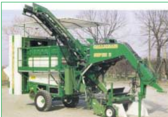
Fig. 1 - Raccoglitrice trainata per la raccolta del pomodoro (Ditta Gallignani).
