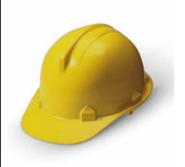
**Caratteristiche**: realizzato in polietilene o ABS, predisposto per essere integrato con cuffia auricolare, visiera e paranuca, con fori di aerazione, bardatura interna con parti tessili, completo di fascetta antisudore, finitura antigraffio, resistente a – 30 °C, isolamento elettrico 1000 V, completo di sottogola regolabile
