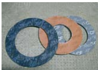
Guarnizioni in fibre di amianto fortemente agglomerate (fonte: IST)
