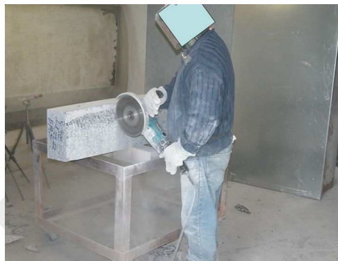
Fig.1: Finitura manuale con fresatrici a disco
