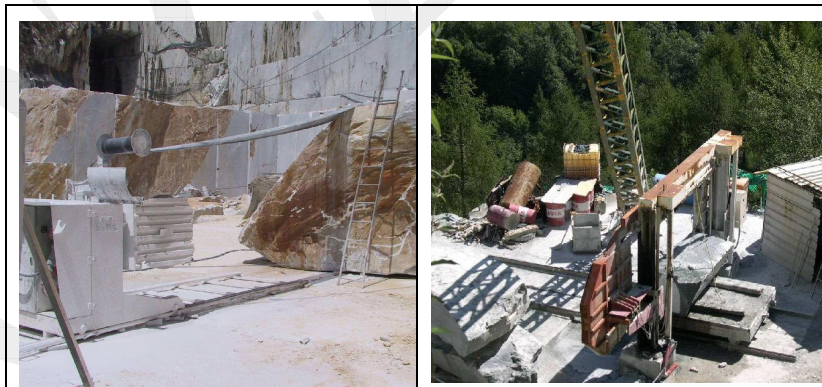
Fig.1: Riquadratura bancata con tagliatrici a filo
