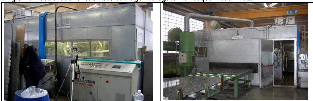
Fig.3-4: Bocciardatrici cabinate con ugelli erogatori di acqua nebulizzata
