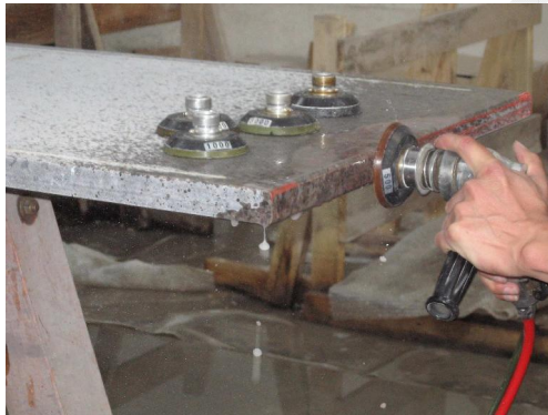
Fig.2: Finitura manuale con smerigliatrici e lucidatrici ad acqua
