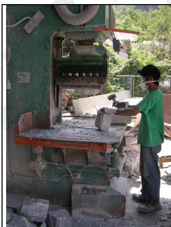
Fig.1-2: : Pavimentazioni: cubettatura a macchina e scalpellatura a mano
