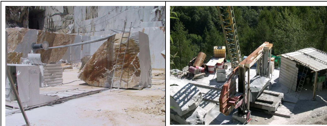
Fig.1-2: Riquadratura con tagliatrice e telaio a filo
