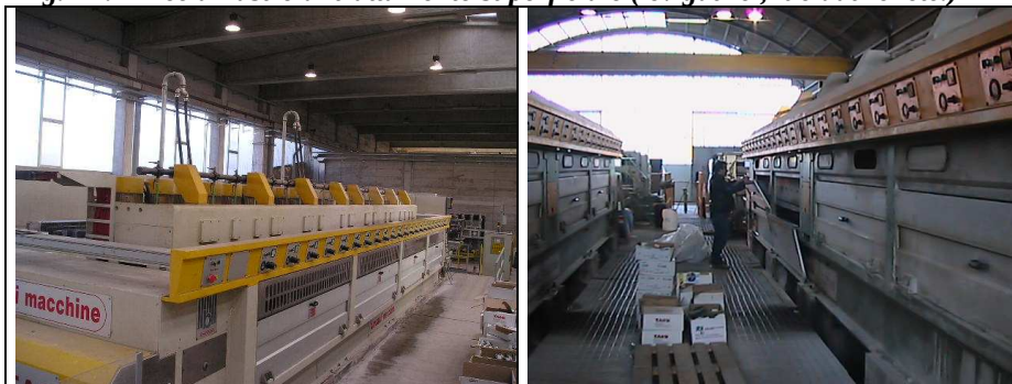
Fig.3-4: Bocciardatrici cabinate con ugelli erogatori di acqua nebulizzata
