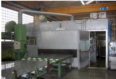
Fig.2: Bocciardatrice cabinata e abbattimento con getti nebulizzatori ad acqua
