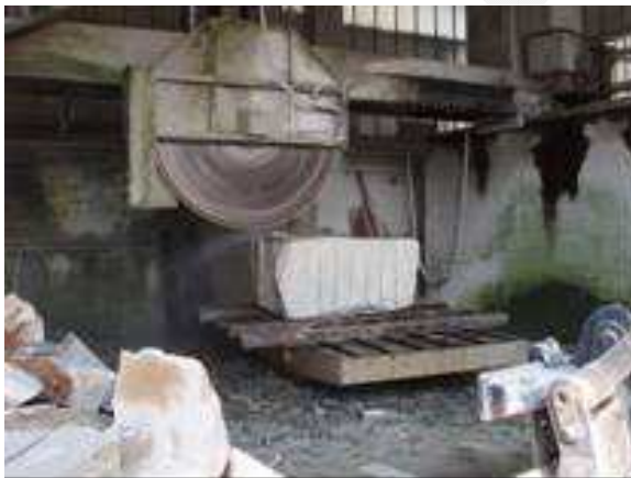
Fig.1-2: Riquadratura con tagliatrice e telaio a filo
