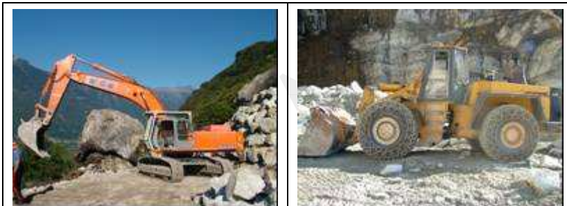
Fig.1: Movimentazione meccanica con automezzi di sollevamento cingolati e gommati
