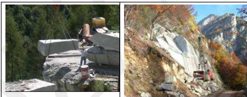
Fig.2: Movimentazione meccanica con mezzi di sollevamento fissi
