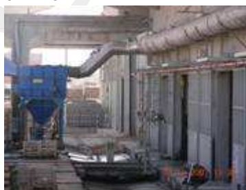
Fig.3: Taglio blocchi con telai multilame in box con aspirazione
