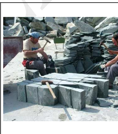
Fig.1-2: : Pavimentazioni: cubettatura a macchina e scalpellatura a mano
