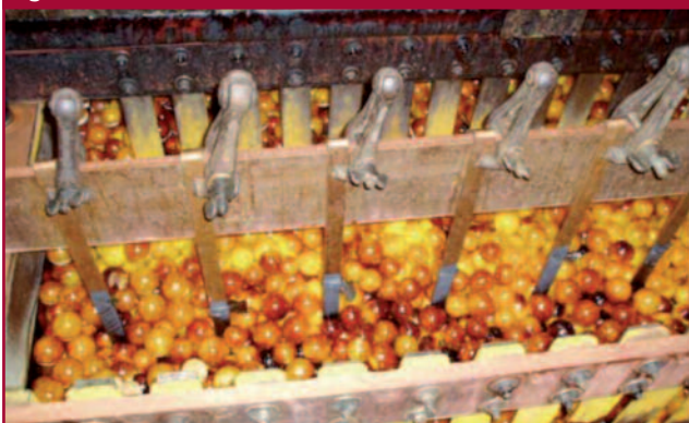
Palline da ping-pong posizionate sulla superficie del bagno di cromatura per aumentare la superficie adsorbente le nebbie di anidride carbonica. (Materiale di archivio)
