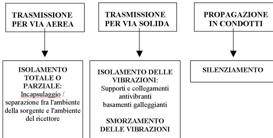
**Figura 6.5:** Tecniche di controllo della trasmissione sonora
