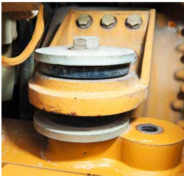
Foto 13 Elemento ammortizzante di un veicolo moderno dotato di cabina di guida antivibrazioni.
