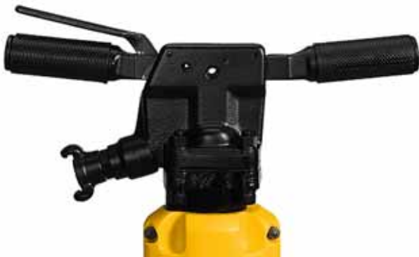
Foto 17 Riduzione delle vibrazioni su un martello demolitore
