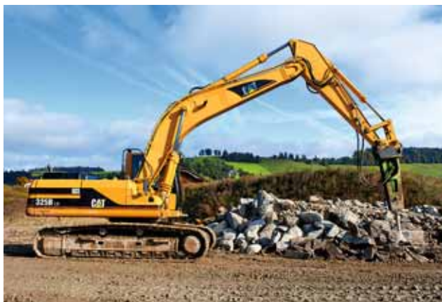
Escavatore cingolato con martello demolitore idraulico
