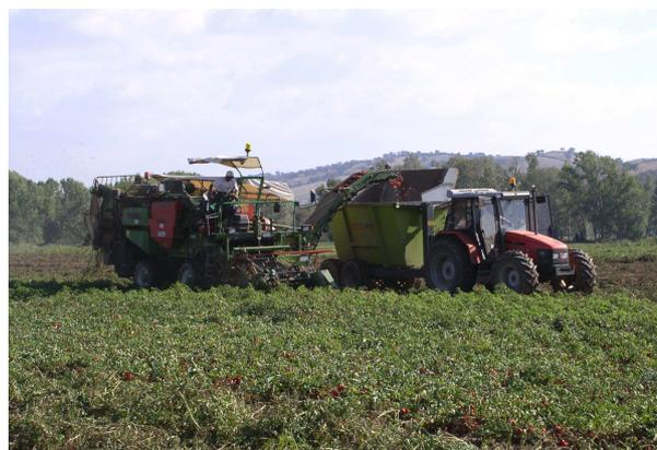
La macchina scarica in continuo il prodotto raccolto in contenitori trasportati da un trattore che avanza parallelamente.
