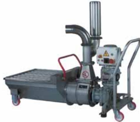
Pompa a rotore ellittico
