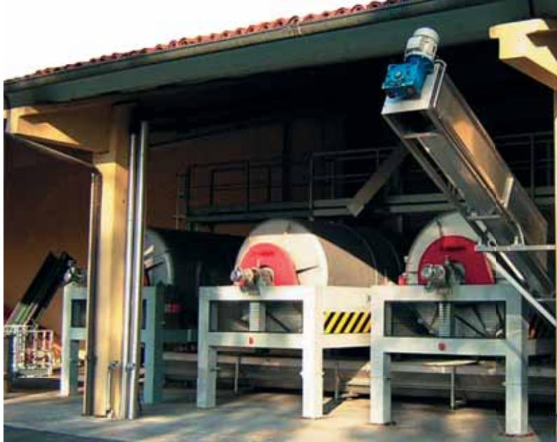
Presse pneumatiche e nastro trasportatore per lo scarico delle vinacce
