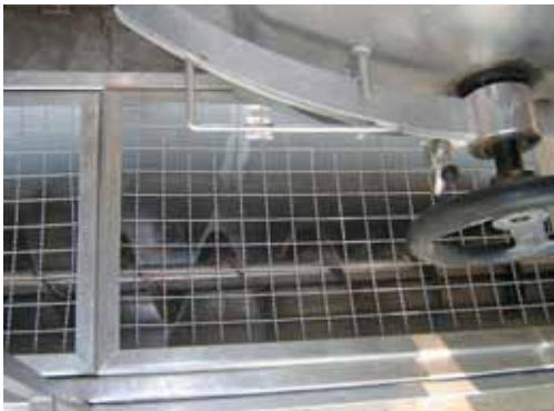
presenti in azienda, tutte le cinghie e le catene di trasmissione devono essere protette da griglie, schermi o carter in grado di impedire qualsiasi contatto anche accidentale da parte dell'operatore.
