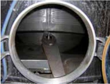
realizzato in acciaio inox, è costituito da una vasca di raccolta mosto ricavata da un setto di separazione nella parte superiore del cilindro, che viene riempita per mezzo di una pompa di rimontaggio centrifuga e collegata al resto del serbatoio da una speciale valvola di grosso diametro, che permette l'alluvionaggio a cascata delle vinacce.
