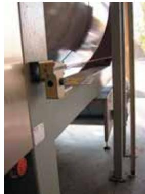
Dispositivo d'arresto e griglie di protezione
