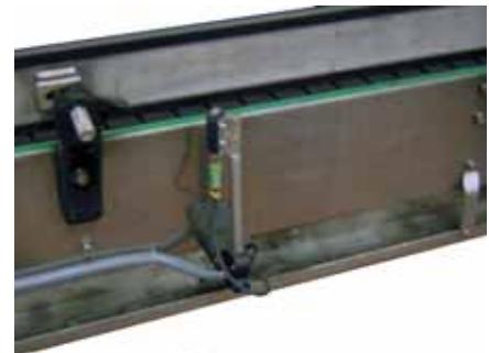
Sensori a fotocellula disposti lungo la linea d'imbottigliamento per il controllo del flusso
