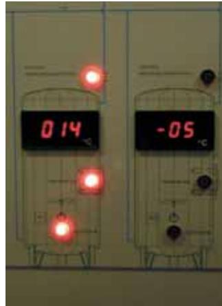
In genere, tali sistemi sono in grado di controllare ed intervenire nel caso si registrino andamenti irregolari della velocità di fermentazione o nel caso di temperature del mosto troppo alte o troppo basse.
