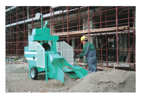
Betoniera autocaricante in fase di caricamento della benna
