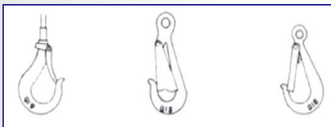
È da tener presente che le diverse condizioni di imbracatura dei carichi (in particolare elevati angoli di apertura delle funi di gancio) fanno diminuire significativamente la portata dell'accessorio usato per l'imbracatura, riducendone pericolosamente l'efficacia.
