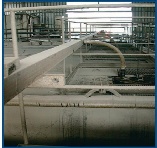
*Fig. 11 Serbatoi stoccaggio bitume*
