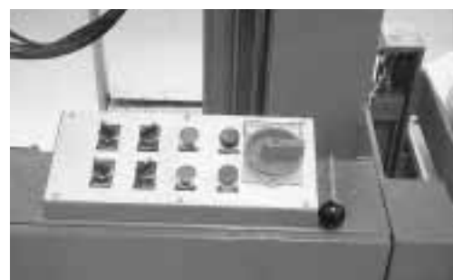
Figura 4: i tasti del quadro comandi sono dotati di una «corona» di protezione per impedire che l'operatore possa premerli accidentalmente.
