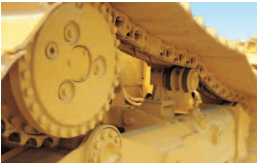
Figura 4 Collegamenti bullonati ad alta sollecitazione per l'unione di flange alla trasmissione finale di un Dozer.
