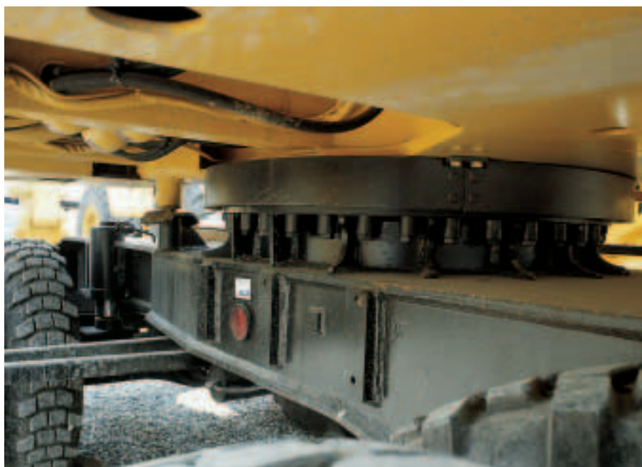
Figura 2 Collegamenti bullonati ad alta sollecitazione alla ralla di un bagger gommato. Le ralle sono un elemento di cui sono dotate anche le gru a torre girevoli, le gru mobili, le pompe per calcestruzzo e altre macchine del genere.
