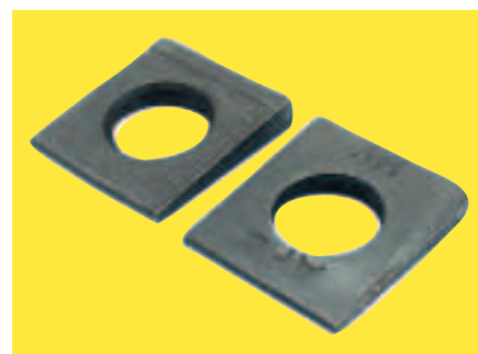
Figura 14 Rondella HV obliqua secondo DIN 6917 con inclinazione del 14% per profili I. Caratteristica: 1 scanalature sulla superficie superiore.
