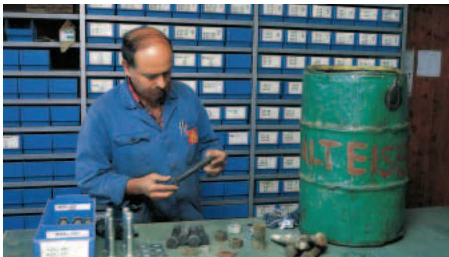
Figura 23 Con un controllo visuale si accerta la riutilizzabilità dei bulloni smontati.
