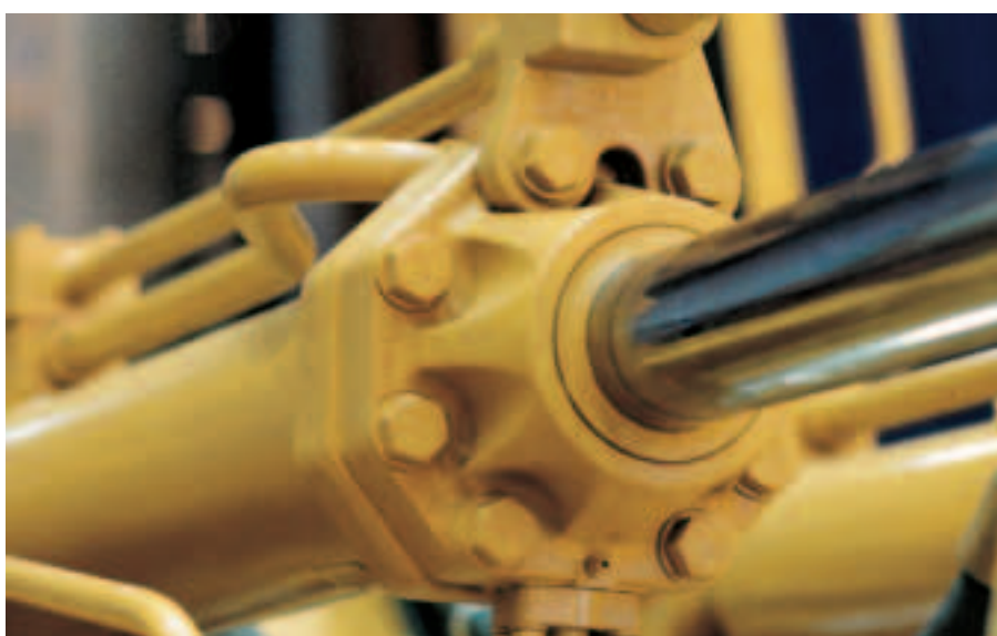
Figura 5 Collegamenti bullonati ad alta sollecitazione a un cilindro idraulico.
