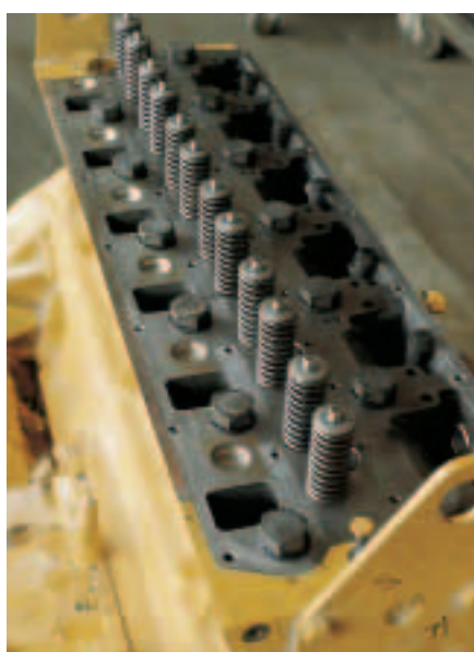
Figura 6 Collegamenti bullonati ad alta sollecitazione alla testata dei cilindri di un motore Diesel.
