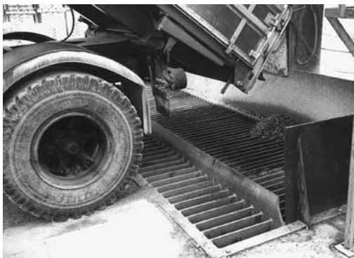
Figura 10: apertura di alimentazione provvista di un grigliato di protezione non destinato al passaggio degli addetti. Tra le sbarre della copertura si possono avere luci della larghezza fino a 80 mm al massimo. Le maglie della griglia possono avere un'ampiezza massima di 150 x 150 mm.
