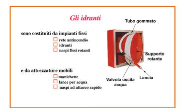
Idranti. Fra gli impianti fissi e gli apparecchi mobili si collocano gli impianti e le attrezzature che utilizzano l'acqua come agente estinguente. Questi sono costituiti da una parte fissa (rete idrica antincendio, idranti, ecc.) e da un insieme di attrezzature mobili (manichette, lance, naspi ad attacco rapido, ecc.). Gli idranti sono attacchi unificati, dotati di valvola di intercettazione ad apertura manuale, collegati a una rete di alimentazione idrica.
