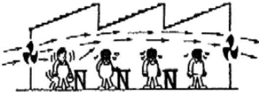
*Fig. 5 - Circolazione dell'aria non corretta derivante da errato posizionamento dei ventilatori d'immissione ed estrazione.*
