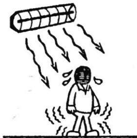
Il sistema di aerotermi è equiparabile a un sistema ad aria calda: la bontà dei risultati dipende solo dal dimensionamento dell'impianto e dalla corretta localizzazione dei diffusori. Abbastanza diffuso è l'uso di diffusori posti sotto la copertura con ventilatore ad asse verticale: per evitare fastidiose correnti d'aria (ancorché calda) il posizionamento e la velocità dell'aria devono essere attentamente definiti in sede progettuale.
