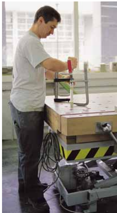
Figure 14, 15 e 16: a seconda della mansione è possibile regolare in altezza la superficie di lavoro del banco da falegname.
