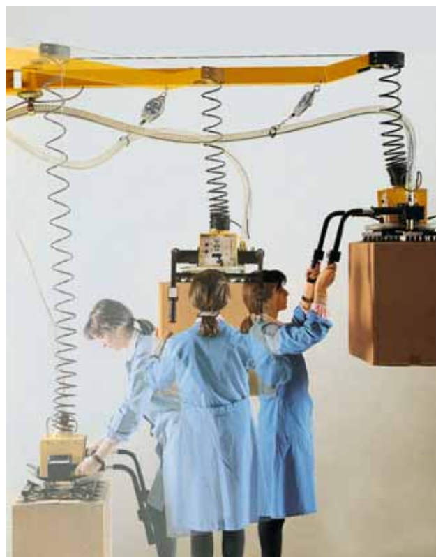
Figura 22: l'impiego di un bilanciatore facilita la movimentazione dei carichi senza un grande impegno muscolare.
