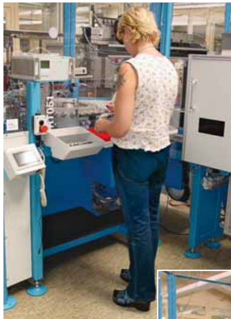
Figura 24 Macchina con piano di lavoro per donne di statura medio-alta.
