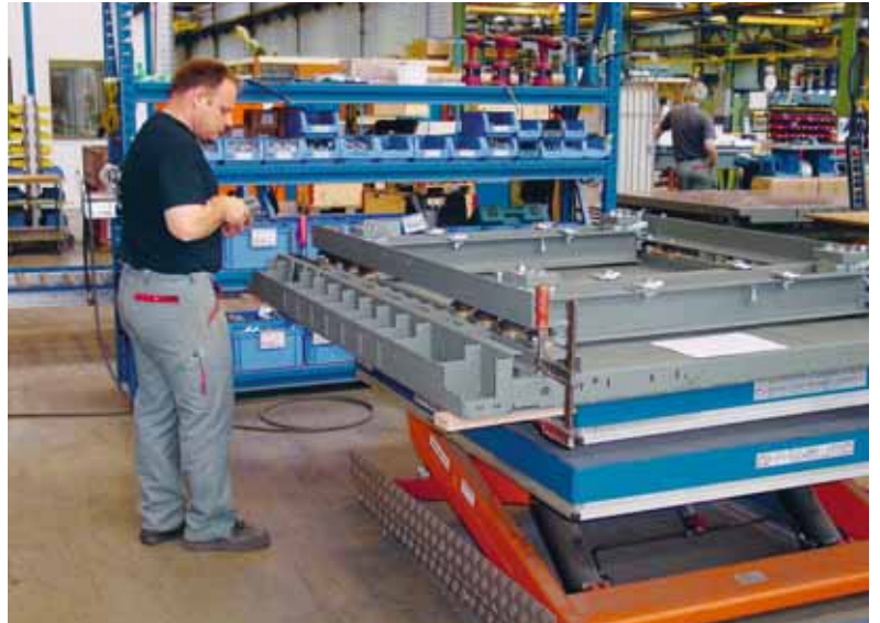
Figura 4 Una tipica postazione in piedi presso un banco su sollevatore a forbice.
