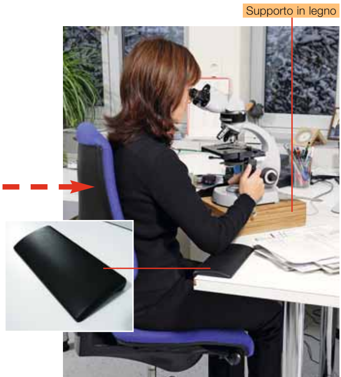
Figura 6 Il supporto in legno consente una posizione corretta. Un appoggio imbottito per le braccia o i gomiti «smussa» gli spigoli del tavolo di lavoro.
