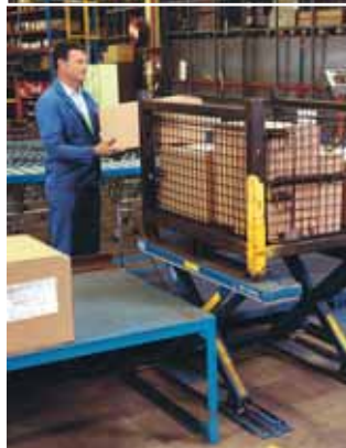
Figura 18 Banco sollevatore elettrico per il carico e lo scarico di contenitori da trasporto.
