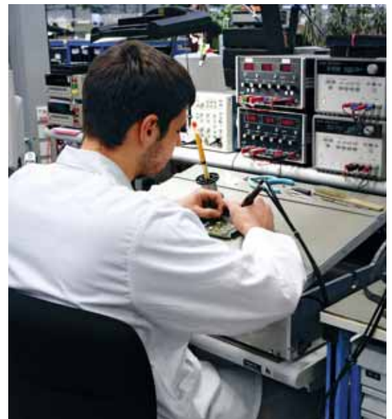
Figura 9 Per lavori con oggetti piccoli è sufficiente posizionare sul tavolo un supporto reclinabile. Il pannello rialzato da un lato facilita la visione.
