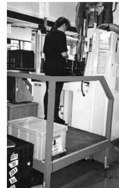
Figura 4: macchina ad iniezione con pedana di lavoro regolabile in altezza tramite dispositivo elettrico.
