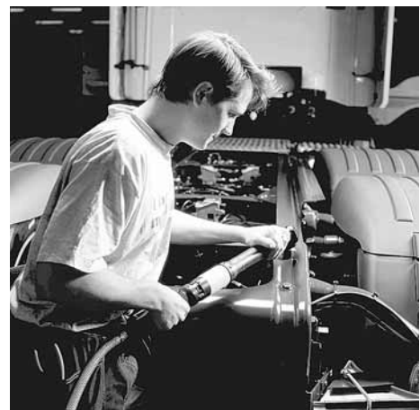
Figura 9: questo cacciavite angolare consente una postura corretta durante il lavoro.
