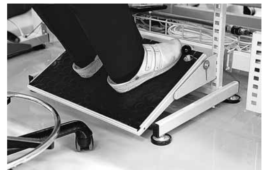
Figura 6: se i piedi non poggiano completamente sul pavimento, è necessario un poggiapiedi regolabile in altezza e inclinazione.
