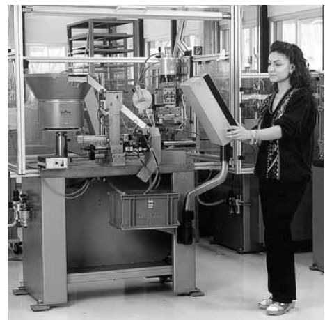
Figura 8: pulsantiera ad un'altezza ottimale per la visualizzazione e la manipolazione dei comandi.
