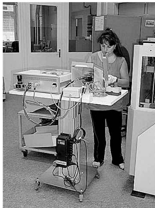
Figure 1 e 2: semplici accessori come carrelli elevatori e piani di lavoro mobili su montanti girevoli e regolabili in altezza permettono di assumere la posizione corretta durante il lavoro.
